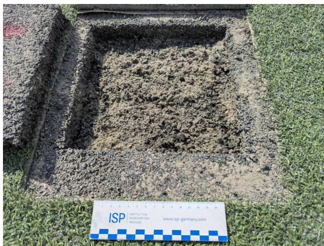
Bild 9: Obere Lage der ungebundenen Tragschicht an Messpunkt 5
