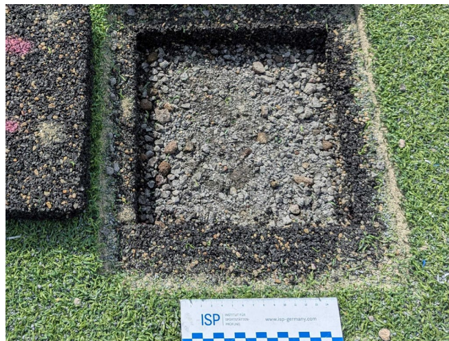
Bild 6: Obere Lage der ungebundenen Tragschicht an Messpunkt 2
