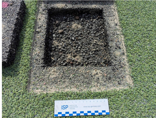
Bild 5: Obere Lage der ungebundenen Tragschicht an Messpunkt 1
