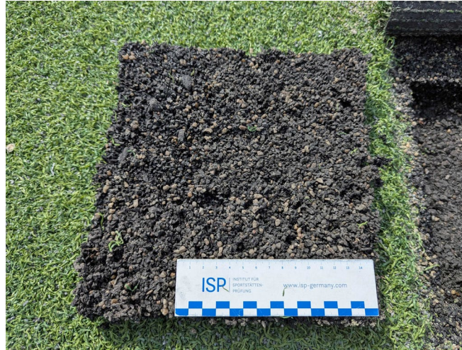
Bild 13: Rückseite der elastifizierenden Schicht an Probenahmestelle 4
