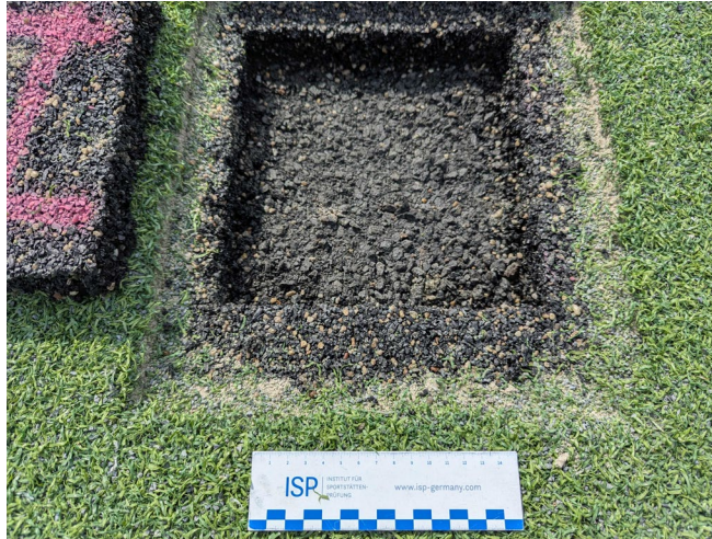
Bild 8: Obere Lage der ungebundenen Tragschicht an Messpunkt 4
