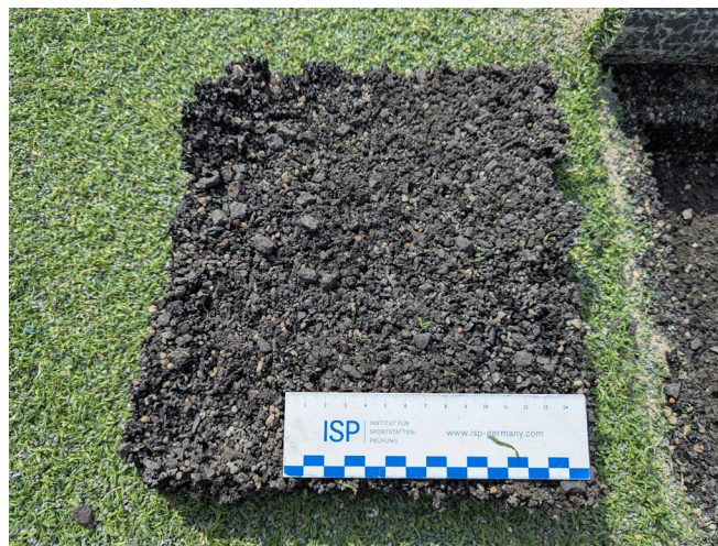
Bild 12: Rückseite der elastifizierenden Schicht an Probenahmestelle 3
