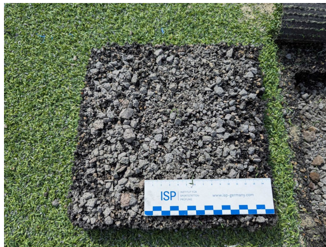
Bild 11 Rückseite der elastifizierenden Schicht an Probenahmestelle 2
