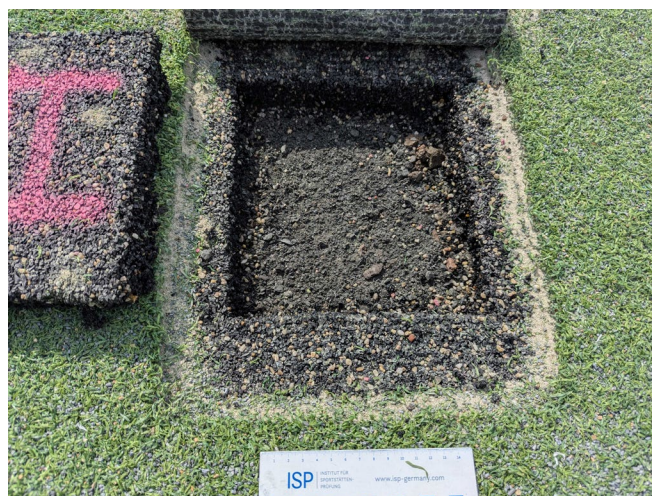
Bild 7: Obere Lage der ungebundenen Tragschicht an Messpunkt 3
