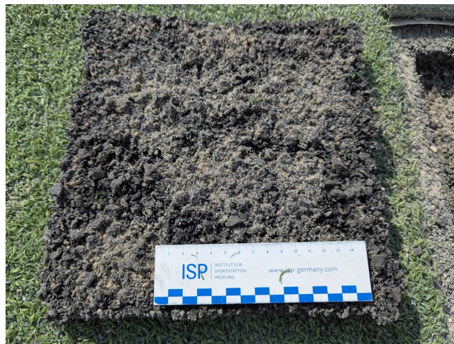
Bild 14: Rückseite der elastifizierenden Schicht an Probenahmestelle 5
