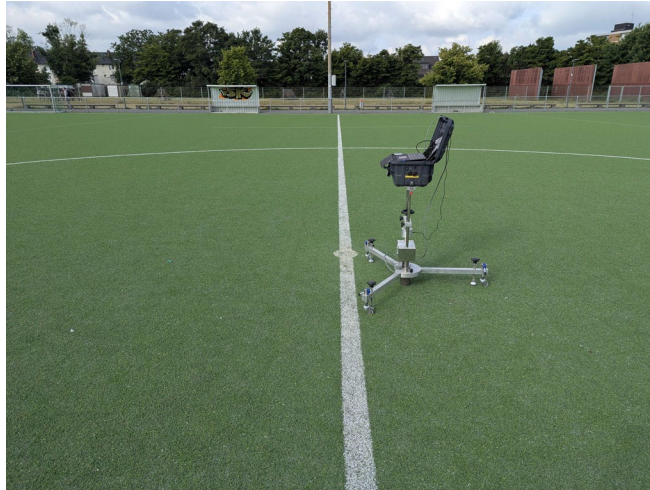
Bild 2: Bestimmung des Kraftabbaus am Gesamtsystem
