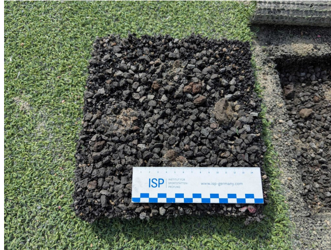
Bild 10: Rückseite der elastifizierenden Schicht an Probenahmestelle 1
