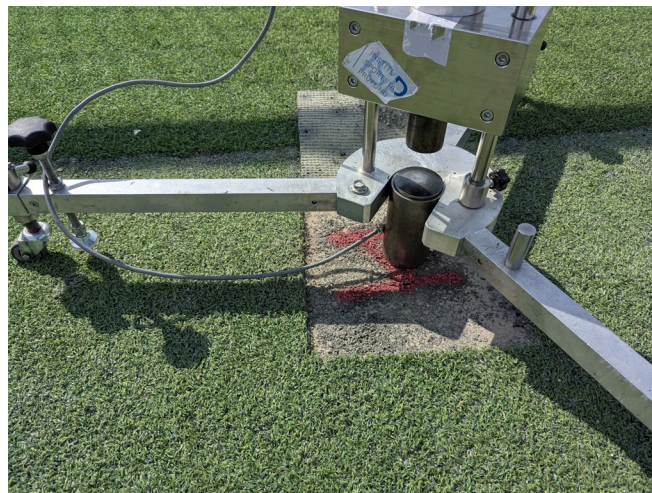
Bild 15: Bestimmung des Kraftabbaus an der elastifizierenden Schicht
